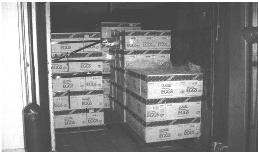
图 20——托盘组装的蛋品。请注意围绕在靠近后门的托盘货物的拉伸薄膜,靠近后门的地方振动最大。
